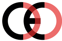
Faux marquage CE (trop proche)
