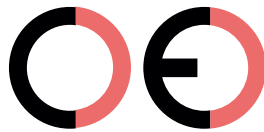
Faux marquage CE (trop éloignée)
